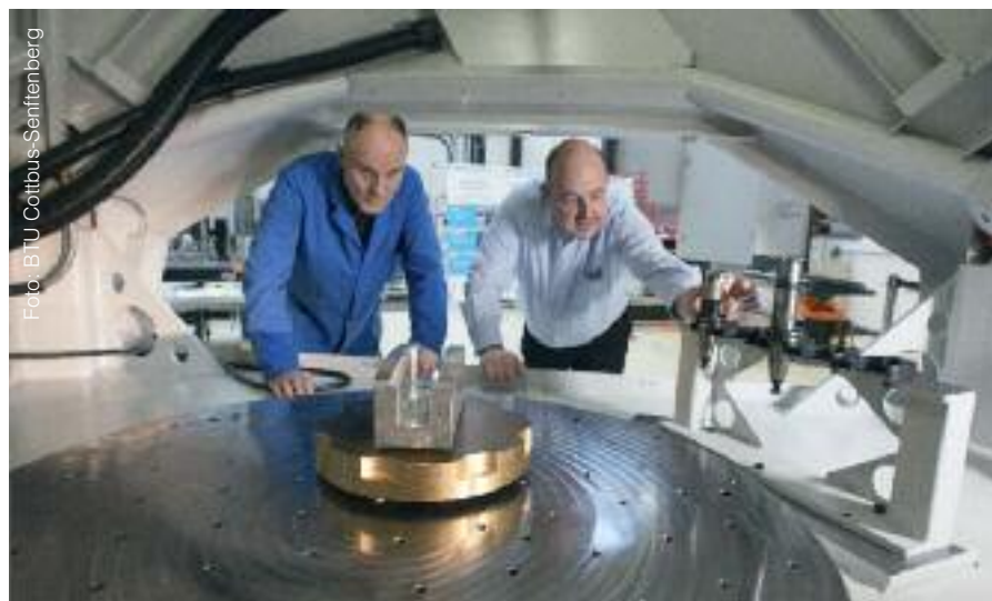
Mit dieser so genannten Parallelkinematik-CNC Fräsmaschine können in der Modellfabrik an der BTU große Bauteile bearbeitet werden.
